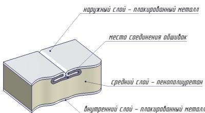
Утеплитель - пенополиуретан - BÜFA-Polyurethane GmbH /Germany/
