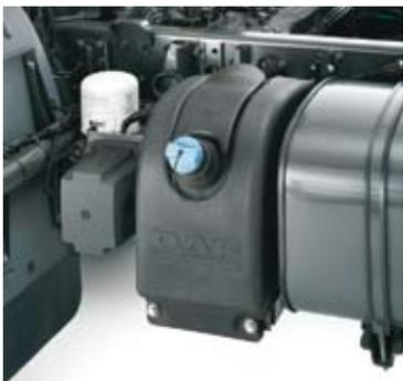
Компактное расположение модуля DAF SCR оставляет достаточно места на шасси для размещения большого топливного бака и другого оборудования.
