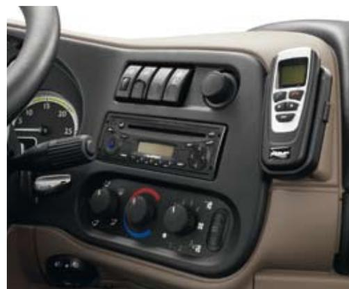
*Предусмотрено специальное место для установки держателя для мобильного телефона, подключенного к кнопкам управления с функцией "hands free" на рулевом колесе.*
