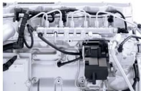
Система впрыска топлива под высоким давлением с общей топливораспределительной рампой для мощных и экономичных двигателей.
